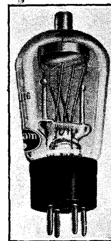
The new high-voltage rectifier.
